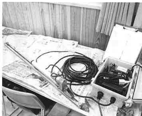
写真2 炭窯用自動クド引き装置
