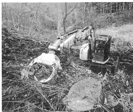
集材機械等を活用した地拵え （一貫作業で伐採者が機械で行う植栽前の準備作業）
