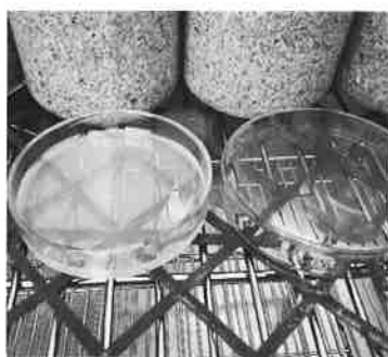
施設内の落下菌検査 (寒天培地を入れたシャーレで 空中の雑菌胞子をキャッチする。)
